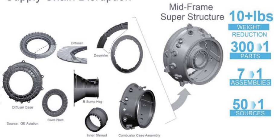
图 38 增材制造对航空发动机轻量化和减少零件数量的贡献(来源: GE Aviation)
